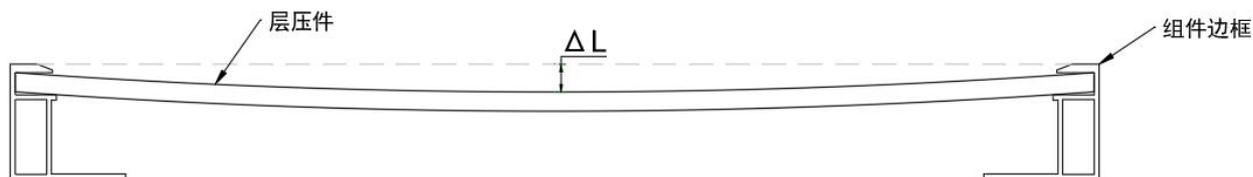
光伏组件跟踪支架安装方式，组件边缘允许的最大形变量  $\Delta L=25\text{mm}$ 。
