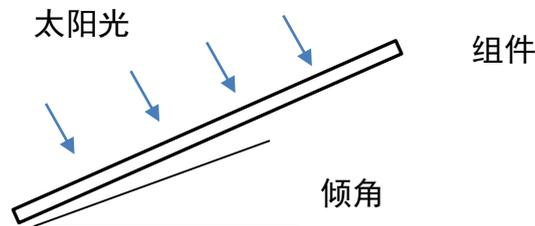
不同的项目因地制宜选择合适的安装倾角，尚德建议在场地允许的条件下，遵循全年发电量最大化的原则尽可能大角度安装，从而减少组件清洗次数，具体的安装角度可依据项目所执行的设计标准或咨询专业太阳能安装人员和系统集成商。对于小角度安装（尚德建议安装角度不低于 $10^{\circ}$ ），建议根据实际情况增加清洗频次，避免长期大量灰尘积累，进而影响组件的外观和性能。
